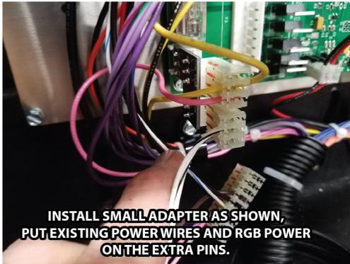
INSTALL SMALL ADAPTER AS SHOWN, PUT EXISTING POWER WIRES AND RGB POWER ON THE EXTRA PINS.
