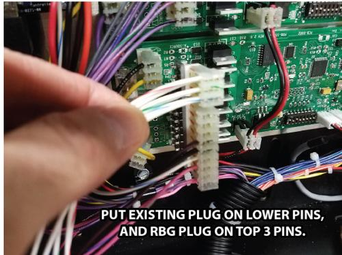
PUT EXISTING PLUG ON LOWER PINS, AND RGB PLUG ON TOP 3 PINS.
